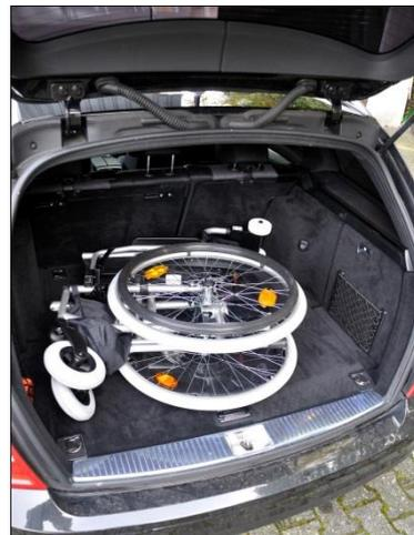
3. Nun können Sie den Rollstuhl rückwärts mit der Verladehilfe auf die Ladekante Ihres Kombi-Pkws kippen, anheben und leicht in den Kofferraum rollen und verschieben.
